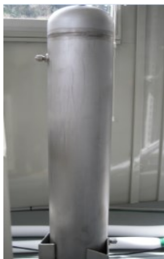
(b) バッファータンク
