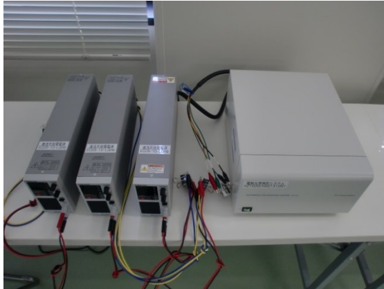
(d) 電気化学測定システム／直流充放電電源
