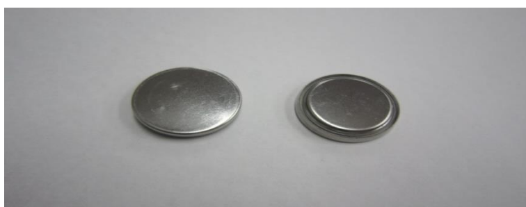
図 3.15 コイン型セルの写真
