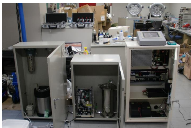
写真 6：固体高分子型燃料電池・改質装置製作状況
