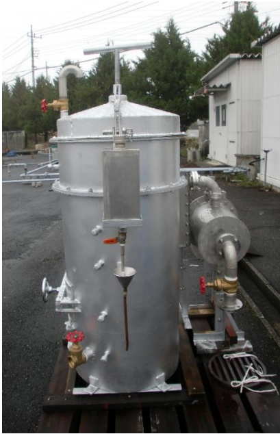
写真1：直接燃焼式木炭水性ガス発生装置・水投入部
