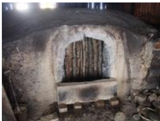
写真 22：立込み完了状況
