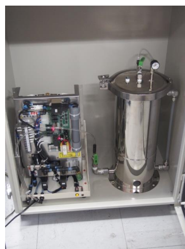
写真 25 : CO 2 除去 PSA 装置
