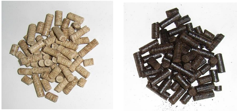
図1 従来の木質ペレット（左）とトレファクションペレット（ハイパー木質ペレット、右）
