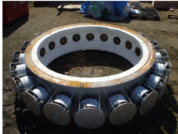
図 10 30kW に拡大するための 20kW 分のユニット
