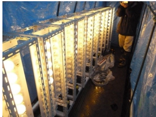
図 21 発電した電気は、照明板で電球を灯して、各エンジンの出力を視覚化している
