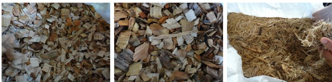
図 10 チップ写真 (左：針葉樹切削、中：広葉樹切削、右：針葉樹破碎)
