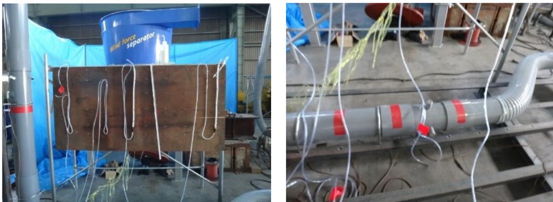
図 8 マノメータ配管（左：差圧測定部分、右：配管接続部分）
