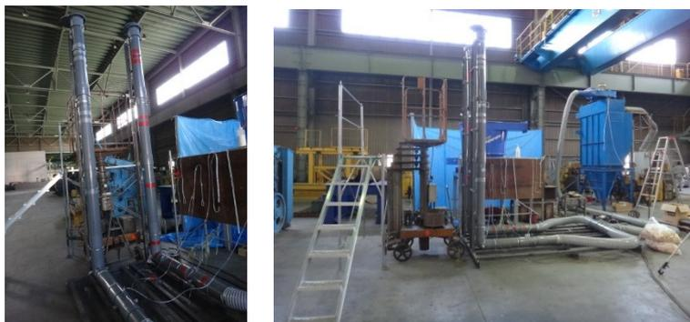
図 7 試験設備（左：垂直配管部分、右：全体）
