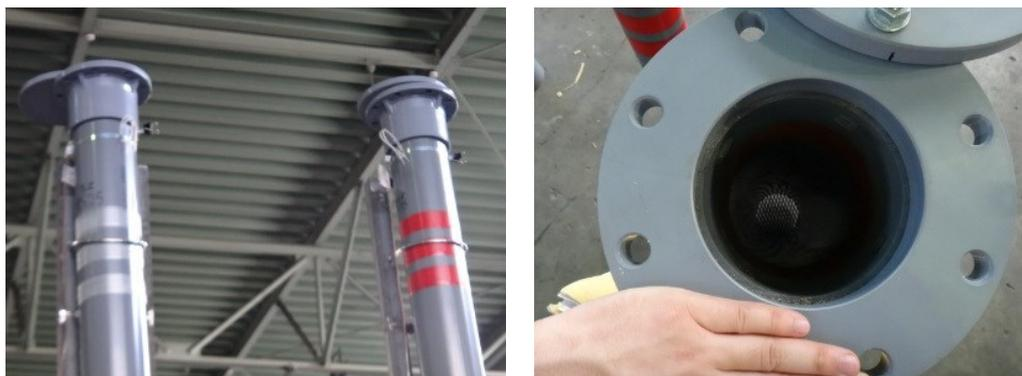
図 9 配管開口部フランジ (左：試験中、右：開口部拡大)
