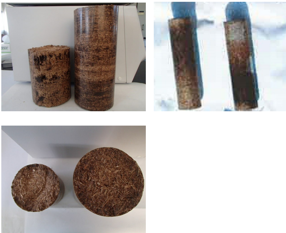
図 15 試験用バイオコークス外観 (左 : 100mm、右 : 40mm)
